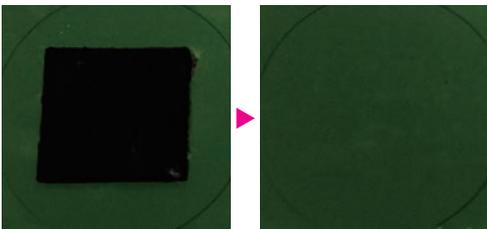
72時間スポット試験後      拭き取り後(簡単に除去)
