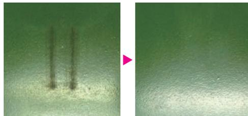
タイヤ片ラビング試験後      拭き取り後(簡単に除去)
