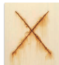
市販品2液型弱溶剤変性エポキシ錆止め
