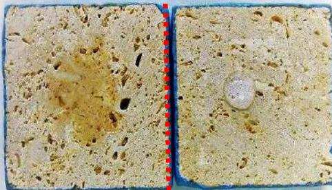
促進耐候性試験（キセノン1,000時間照射後）
