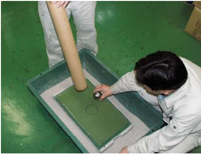
落球衝撃試験 1kg鉄球・1m落下
